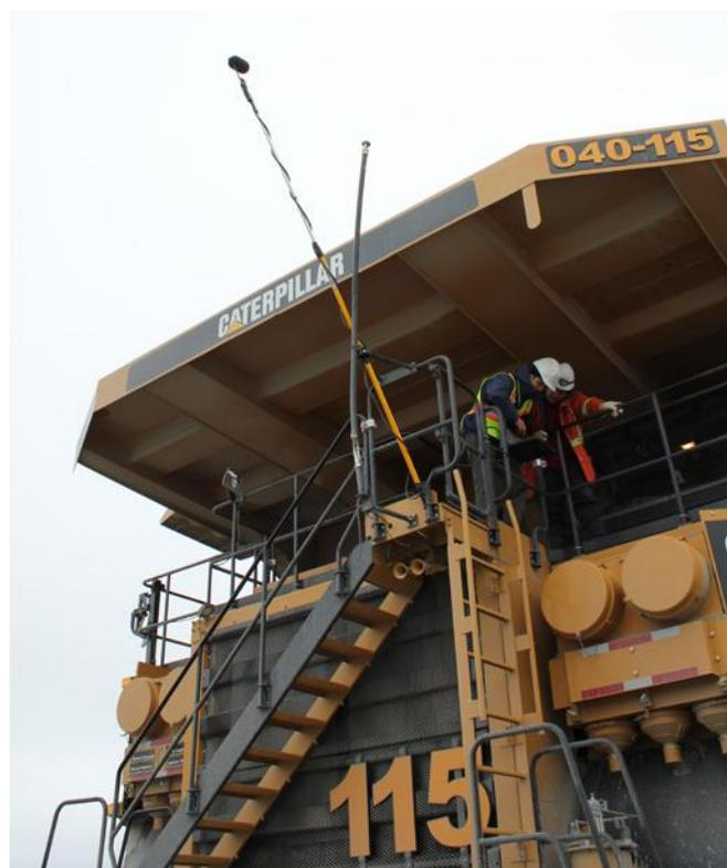
▲ Mesure du bruit sur un camion en mouvement
