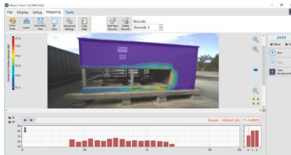
Cette troisième limite délimite tout le côté du DUT. Le niveau de puissance acoustique de cette section est de 76,2 dBA.
