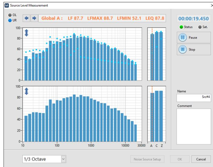
Lorsque vous êtes prêt à arrêter la mesure, cliquez sur le bouton Arrêter ou appuyez sur le bouton central de la baguette du microphone.
