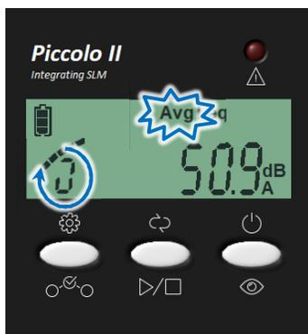
Une fois que la mesure est démarrée, l'affichage indique le niveau sonore équivalent de la mesure en cours.
