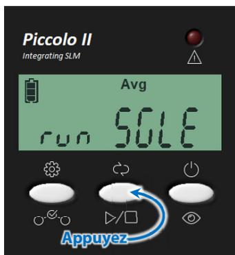
Appuyez sur le bouton du centre pour démarrer une mesure unique. Lors du démarrage de la mesure, l'affichage indiquera « run SGL » pendant 1s.
