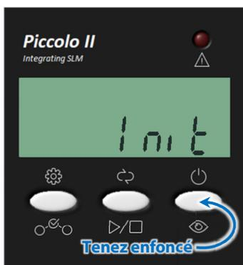
Tenez le bouton de droite enfoncé pour démarrer le sonomètre. Le sonomètre affiche « Init » durant le démarrage qui dure environ 1s.
