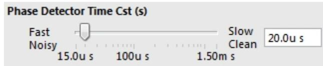
Cette commande permet de régler la constante de temps du détecteur de phase. Nous suggérons de maintenir la constante de temps à 20us (réglage rapide), ce qui permet une largeur de bande d'environ 8 kHz. Notez que les fonctions d'auto-ajustement des gains PI des deux contrôleurs (amplitude et phase) fixent automatiquement la constante de temps à 20us. De cette manière, la largeur de bande du régulateur n'est limitée que par les gains PI et le filtre LP.
